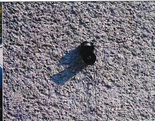
Fot. 8 Jeden z odstraszaczy dźwiękowych z zamontowanym czujnikiem ruchu – reagującym na przelatujące ptaki
